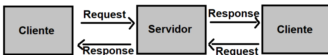
Figura 2.3: Conexão entre computadores com papel de cliente e computadores com papel de servidor.
